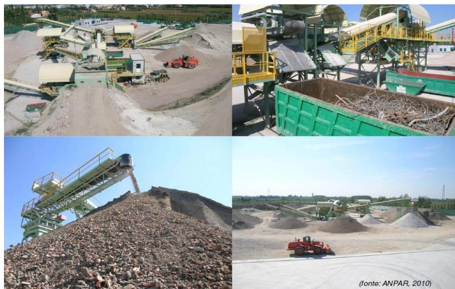
*Figura 25: Impianto fisso di trattamento a secco a tecnologia R.O.S.E. in Italia*
