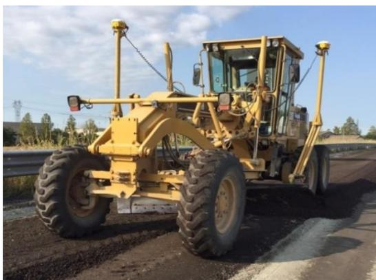
*Figura 73: Greder (mezzo movimento terra) dotato di livella collegata ad un sistema GPS.*
