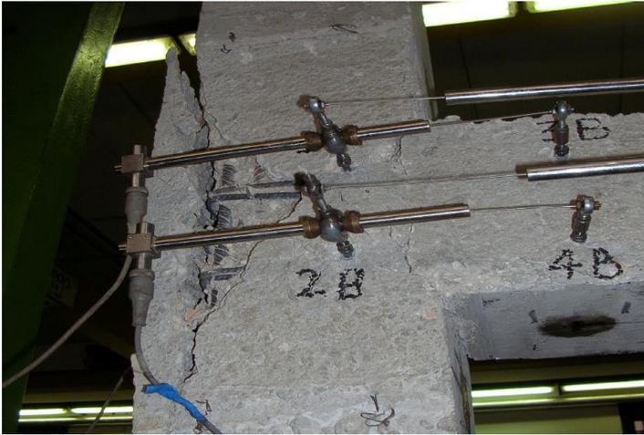
Figura 54: Deterioramento del nodo di tipo A sotto l'azione di carichi ciclici.
