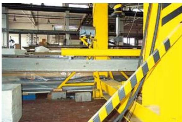
Figura 132: Prova di flessione su un travetto confezionato con materiale riciclato.
