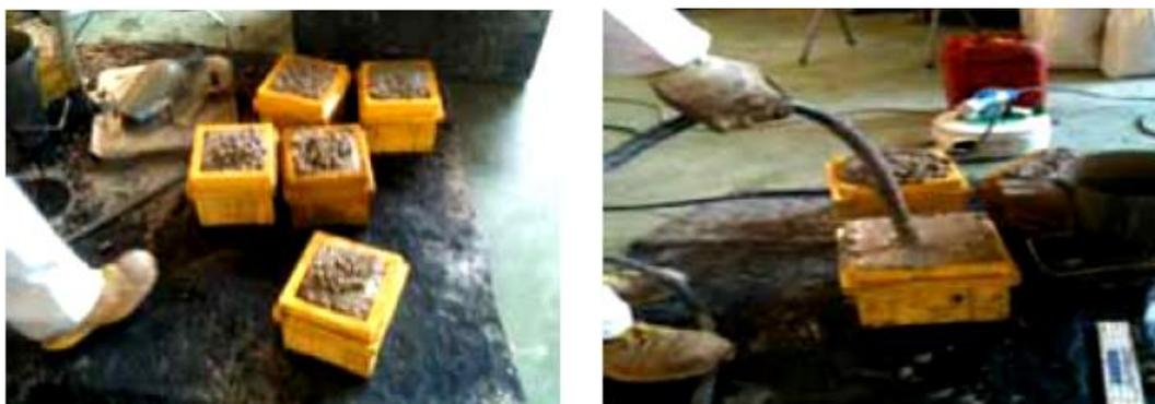
Figura 106: Riempimento dei casseri e costipamento a rifiuto tramite vibratore ad ago.
