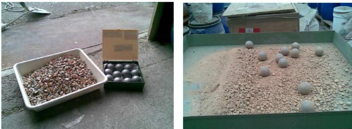
Figura 46: Materiale e sfere prima della prova (sinistra) e materiale residuo dopo prova (destra).
