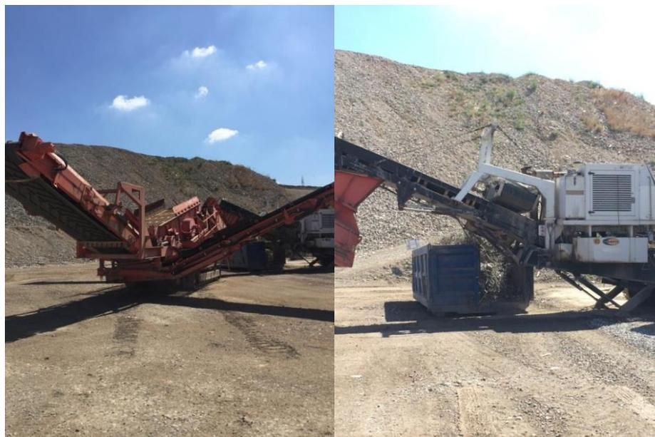
*Figura 69: Dispositivo di frantumazione mobile e deferrizzatore.*
