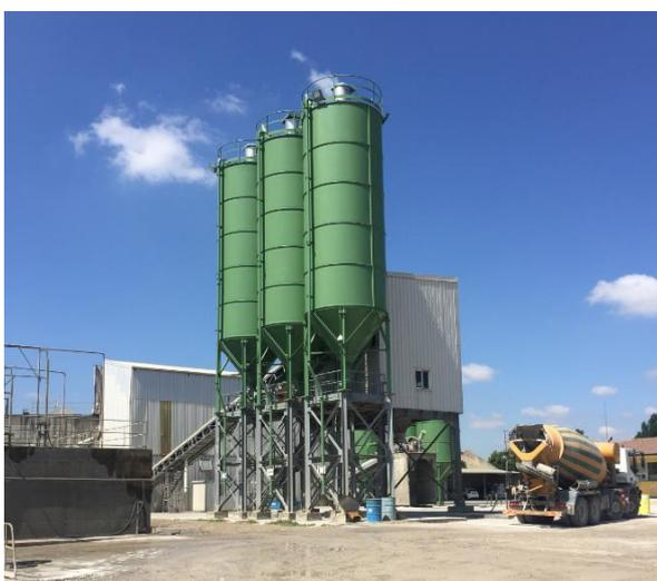
*Figura 72: Miscelatore del calcestruzzo con tramogge contenenti i vari componenti.*
